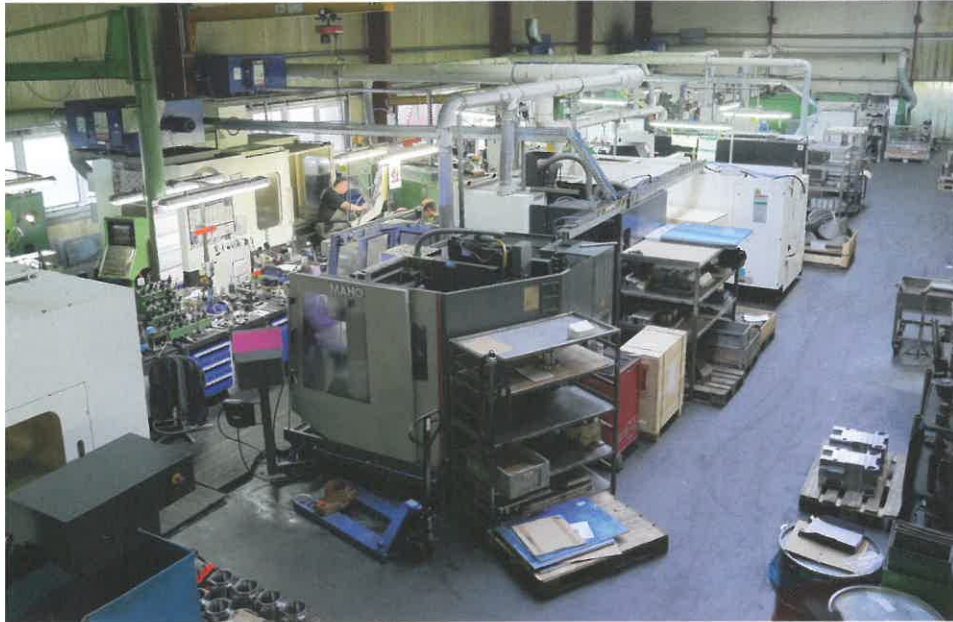
1 Die komplette Halle wurde mit Elofil-Elektrofiltern nachgerüstet. Bei niedrigen Betriebskosten herrscht jetzt effektiv reine Luft
