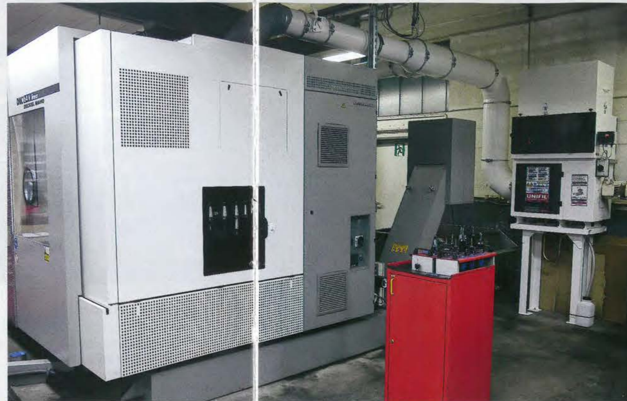
Unifil 1MRV60 an einem Bearbeitungszentrum. Über den digitalen Filtermonitor wird der Betriebszustand des Gerätes permanent überwacht und angezeigt.
